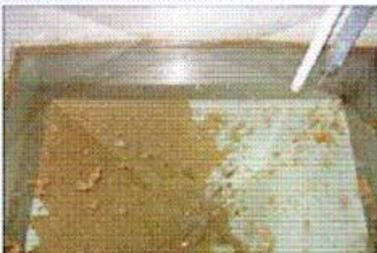
Starker Algenwachstum in einem offenen Frischwasserbehälter einer Flüssigfütterung
