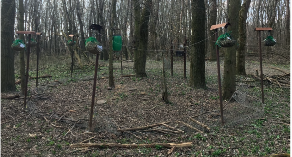
Abbildung 1: NET-UP Falle im Waldeinsatz. Flexible Anpassung an unterschiedliches Terrain und Aufbau unter Einbeziehung verschiedener Vegetation für eine natürliche „getarnte Erscheinung“.
