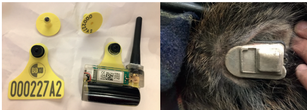
Abbildung 3: RSSI Ohrmarkensender und Zeichnungsmarke (links); GPS Sender vom Max-Planck-Institut mit SIGFOX OG Technik (rechts)
